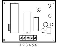
Речевой информатор подключается к централи параллельно COMBUS порту. Уровень громкости регулируется переменным резистором.
